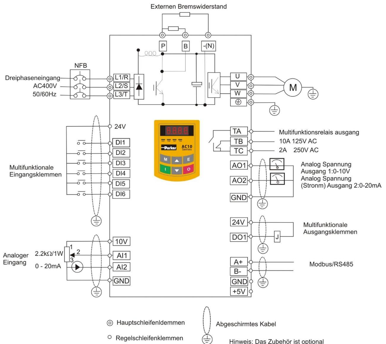
0,2 kW - 22 kW Grundverdrahtungsschema Mehrstufige Geschwindigkeitssteuerung Makro (PNP)
