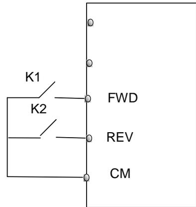
**2: Zweileitungsbetriebsmodus 2:** Wenn dieser Modus verwendet wird, ist FWD die Aktivierungsklemme und die Richtung wird durch die Klemme REV geregelt.
