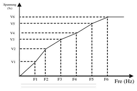
Abbildung 9-4 Polygonalzeilen-VVVF
