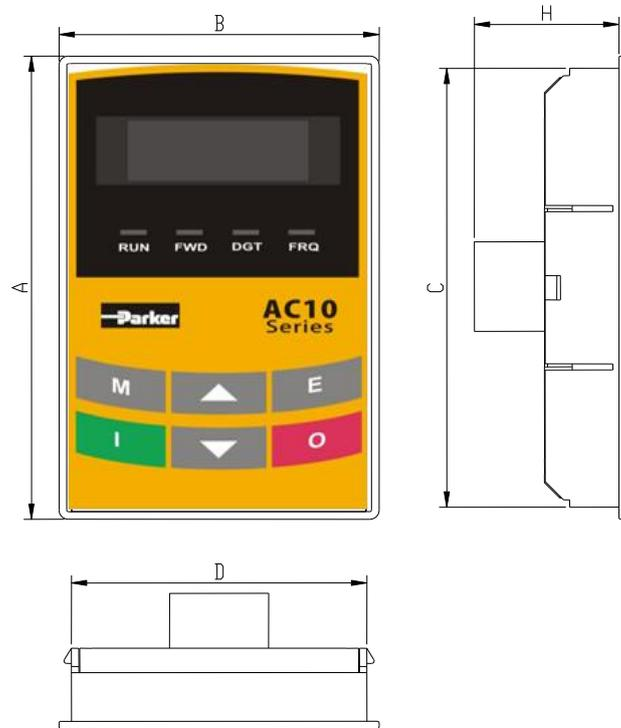
Abmessungen des Tastenfelds (Einheit: mm)
