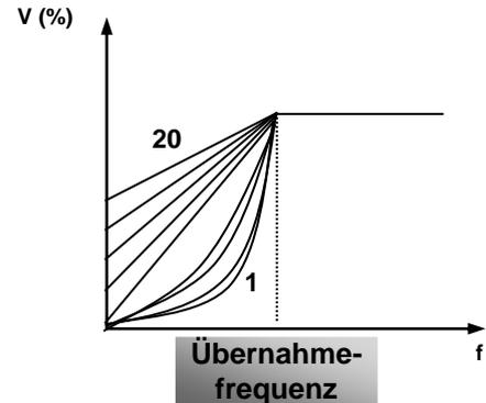
Abbildung 9-3 Drehmomenterhöhung
