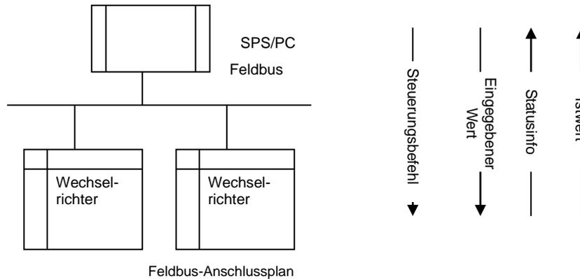
Im Wechselrichter AC10 wird der Halbduplex-Kommunikationsmodus der Schnittstelle RS485 verwendet. Die RS485-Bus-Leitung verwendet eine Daisy-Chain-Struktur. Verwenden Sie keine Stichleitungen oder Sternkonfiguration. Die von Stichleitungen oder Sternkonfiguration reflektierten Signale stören die Kommunikation der Schnittstelle RS485.
