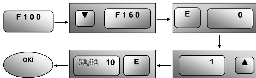
Abbildung 9-5 Zurücksetzen auf Werkseinstellungen
