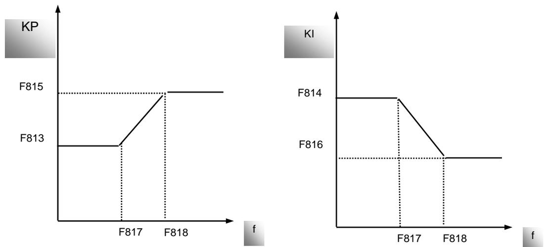
Abbildung 9-14 PID-Parameter
