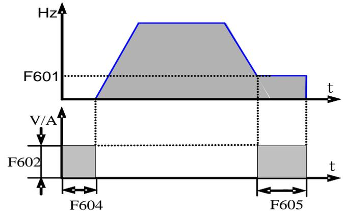
Abbildung 9-11 Gleichstrombremsung
