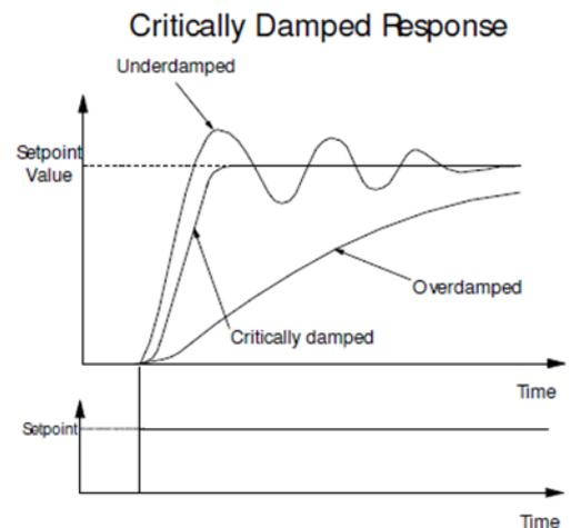
Derivative Verstärkung Reaktion in einigen Tänzerin Spannung Kontrollsysteme, insbesondere jenen Systemen mit hohem Trägheitsmoment Tänzer, die eine sofortige Reaktion benötigen, um das Gewicht der Tänzerrolle zu überwinden, zu verbessern. Für Wägezelle kontrollierter Spannung Systemen wird Ableitungsverstärkung fast nie benutzt.
