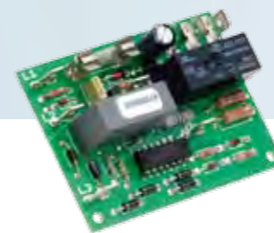
Controllo del senso di rotazione con rilevamento della mancanza di fase
