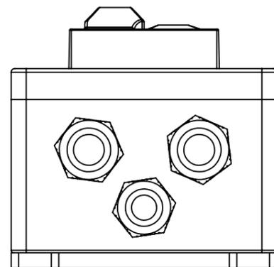
Netz M20    Not-Aus M16    Motor M20
