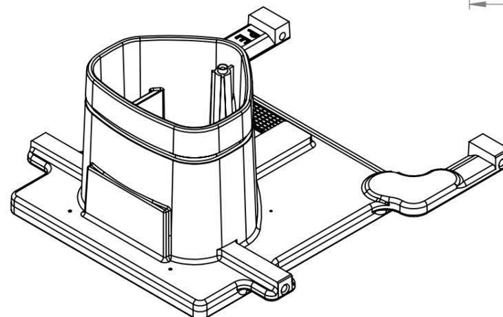
Wenn die Befestigungsbohrungen außerhalb der angegebenen, schematisch dargestellten Positionen gesetzt werden, so müssen Senkschrauben zum Einsatz kommen.
