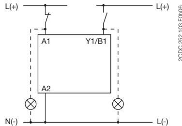
Der Steuereingang **Y1/B1** wird über elektrisches Potential an A2 angesteuert. Dazu kann die Steuerspeisespannung von Klemme A1 oder jede beliebige andere Spannung innerhalb des zulässigen Steuerspeisespannungsbereichs verwendet werden.
